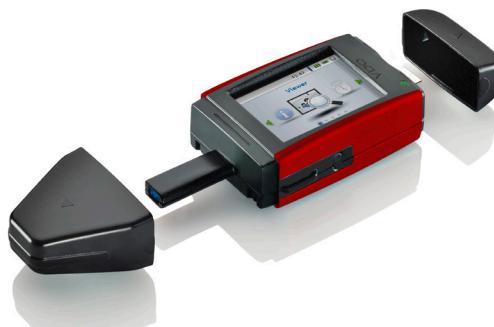
Крышки прибора оберегают его от загрязнения разъемов, что особенно важно учитывая условия эксплуатации прибора;
